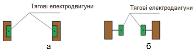
Рис.2 Основні типи розміщення мотор-колеса: а) мотор-колесо розміщено в середині ободу; б) мотор-колесо розміщено на спеціальній конструкції. Для передачі обертального моменту використовуються додаткові механічні конструкції
