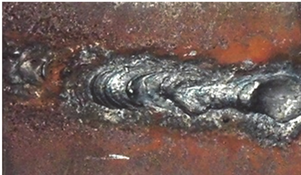
Рис. 3. Загальний вигляд зрізця після обробки графітовим електродом
