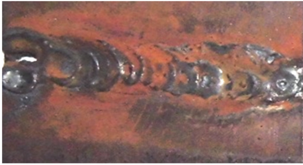
Рис. 2 Загальний вигляд зрізця після обробки вугільним електродом
