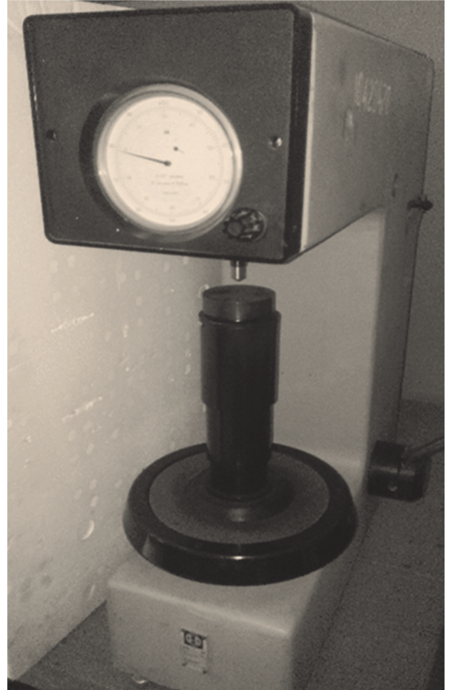
Рис. 5. Загальний вигляд твердоміра (марка 2140 ТР).
