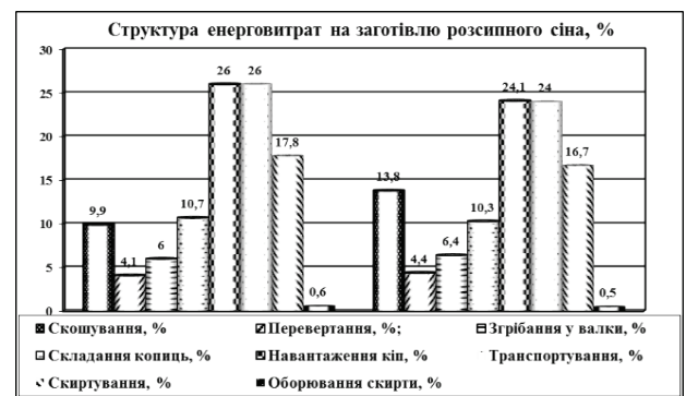
Рис. 4. Структура енерговитрат на заготівлю розсипного сіна
