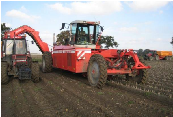
Рис. 5. Самохідний картоплекопач-навантажувач SF 1700 DLS
