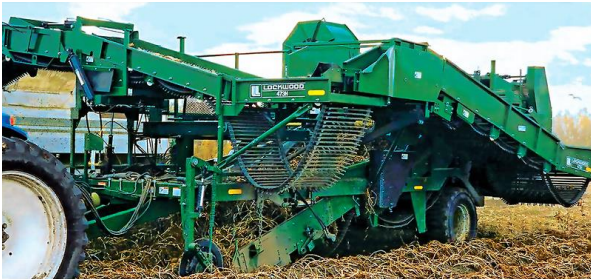
Рис. 4. Картоплекопач-навантажувач 472Н фірми Lockwood
