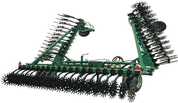
Рис. 4. Борона ротаційна БРП-9,7 («Технополь»)
