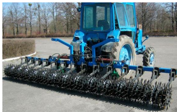
Рис. 3. Борона зубова міжрядна БЗМ-5,6, «Хмільниксільмаш»
