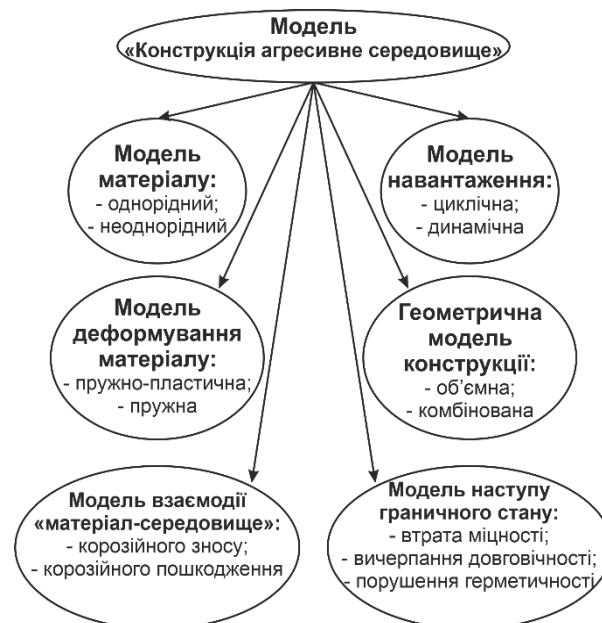
Рис. 2. Схема моделі «Конструкція - агресивне середовище»
