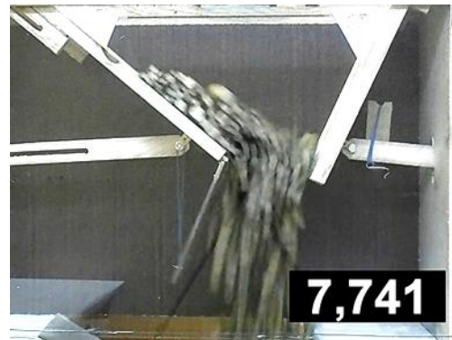
Рис. 7. Окончание выгрузки черенков при углах установки наклонных стенок \alpha = 65^\circ и \beta = 40^\circ
