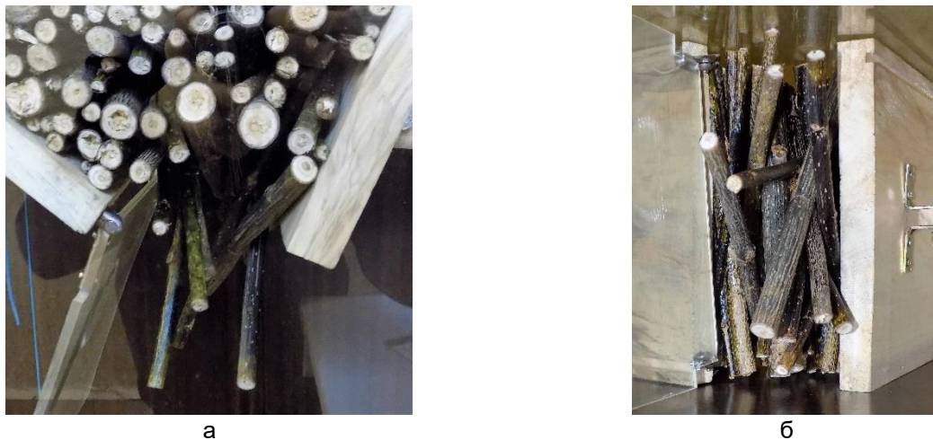
Рис. 8. Проблемы выгрузки черенков энергетической ивы в зоне выгрузного окна
