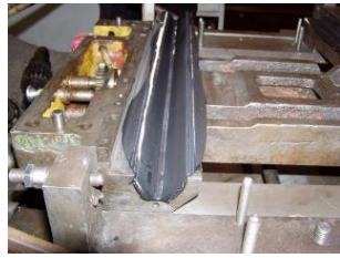
Рис. 3 - Ремонт ротора турбокомпрессора ГТТ - 3 методом ЕІЛ (а) з наступним ППД (б).
