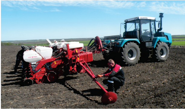
Рис. 3. Экспериментальная сеялка Vega 8 Profi под смешанные посевы двух технических культур производства ПАО «Эльворти»
