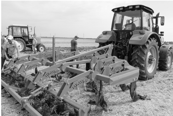
Рис. 1. Зовнішній вигляд машинно-тракторного агрегату у складі трактора МТЗ-3022ДЦ.1 і чизельного плуга
