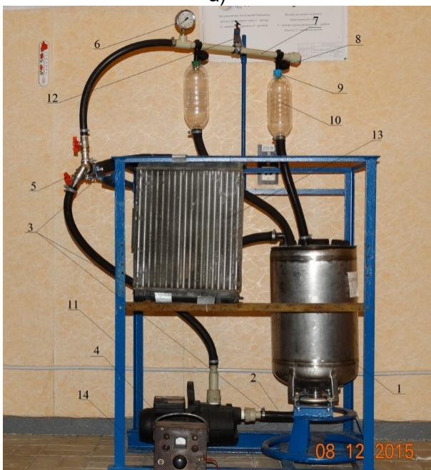
Рис. 2. Стенд для ресурсних випробувань розпилювачів: а — принципова схема; б — загальний вид; 1 — місткість; 2 — забірник; 3 — рукав; 4 — насос; 5 — регулятор тиску; 6 — манометр; 7 — штанга; 8 — розпилююча головка; 9 — розпилювач; 10 — лійка; 11 — рама; 12 — тримач; 13 — радіатор; 14 — перетворювач.
