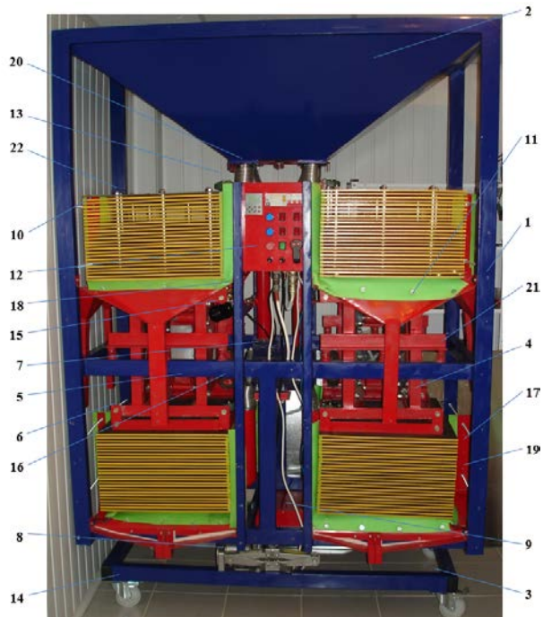
Рис. 1. Мехатронна мультиплощинна вібраційна насіннесочисна машина: 1 – проміжна рама; 2 – бункер насіння; 3 – платформа; 4 – рама вібробуджувача; 5 – вібробуджувач; 6 – рама площин; 7 – електродвигун; 8 – електродомкрат; 9 – блок живлення; 10 – сепаруючі площини; 11 – напрямні; 12 – блок управління; 13 – живильник; 14 – колісний механізм; 15 – моторредуктор; 16 – муфта; 17 – роздільна планка; 18 – муфта приводу живильника; 19 – гвинтові напрямні; 20 – гнучкий патрубок; 21 – пружини; 22 – таровані шайби
