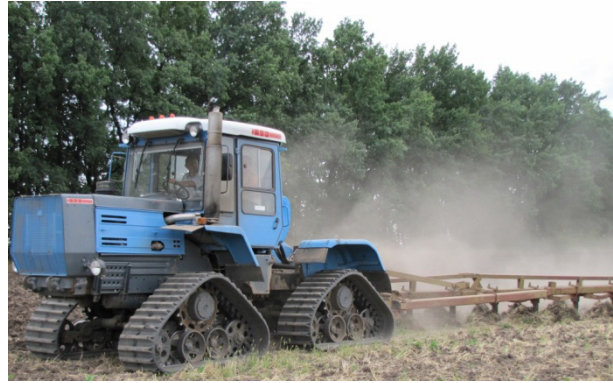
Рис. 5. Трактор ХТЗ-280Т з гумово-тросовими гусеницями, при агрегуванні з плугом ПЛН-8-35
