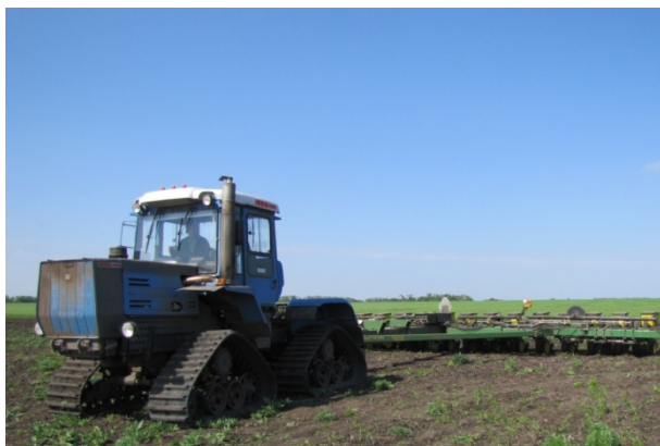
Рис. 3. Трактор ХТЗ-280Т в агрегаті з просапною 12-рядковою сівалкою John Deere 7200
