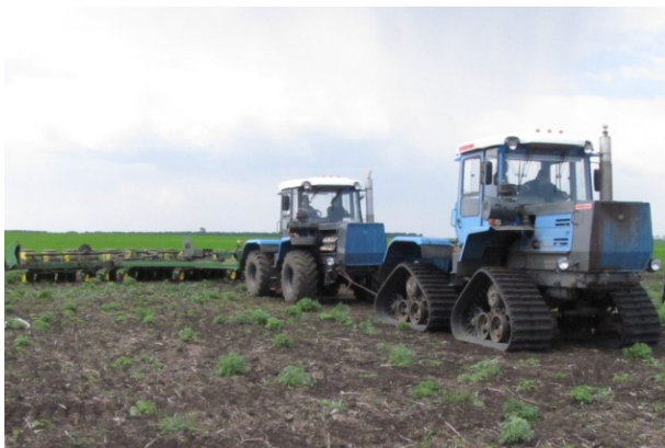
Рис. 2. Дослідження роботи трактора ХТЗ-280Т по визначенню буксування
