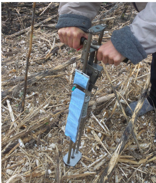
Рис. 6. Визначення твердості ґрунту
