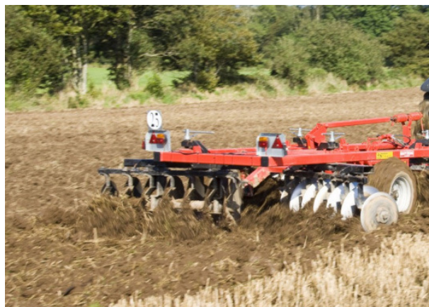
Рис. 1. Робочий процес дискування ґрунту бороною Quivogne APXTL
