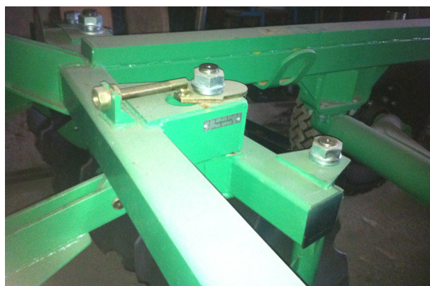
Рис. 2. Регулювання глибини дискування за допомогою зміни кута атаки на агрегаті УДА-3,1
