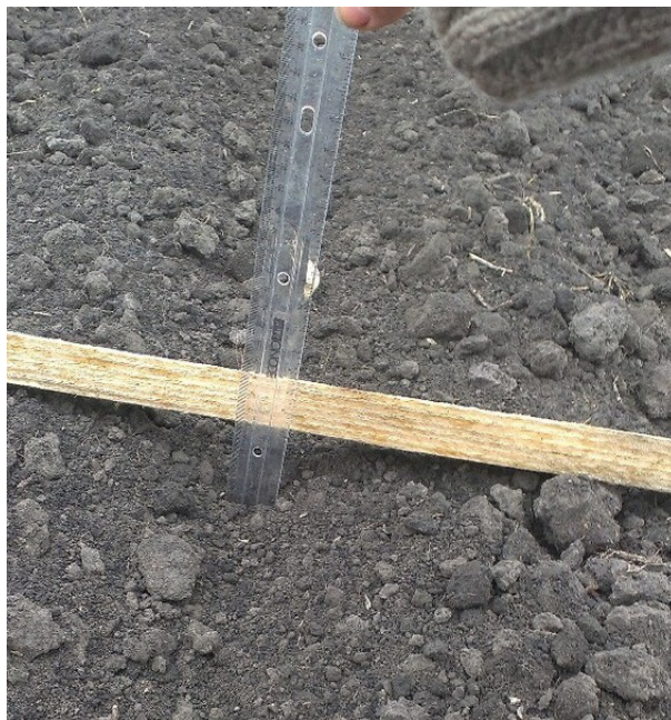
Рис. 5. Визначення гребенистості поверхні ґрунту після дискування
