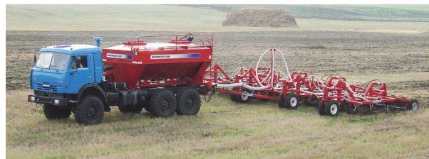
Рис. 3. Посівний комплекс «Agrator-8500 АВТО» на базі автомобіля КамАЗ
