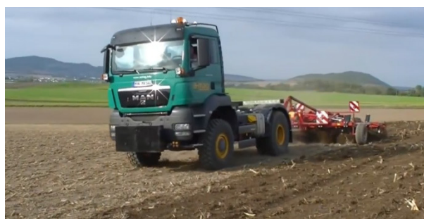
Рис.4. Грунтообробний агрегат на базі автомобіля «MAN»
