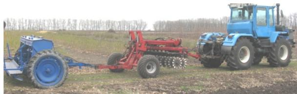
Рис. 1. Приставка прямого сева ППС-5,4 в агрегате с зерновой сеялкой СЗ-5,4-06
