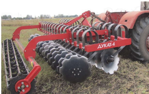
Рис. 1. Борона «Дукат-4» з пружинними стійками кріплення дисків
