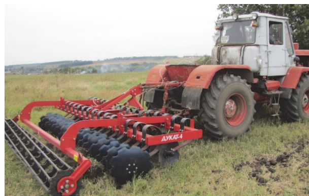
Рис. 3. Дискова борони-луцильника «Дукат-4» в агрегаті з трактором Т-150К-09
